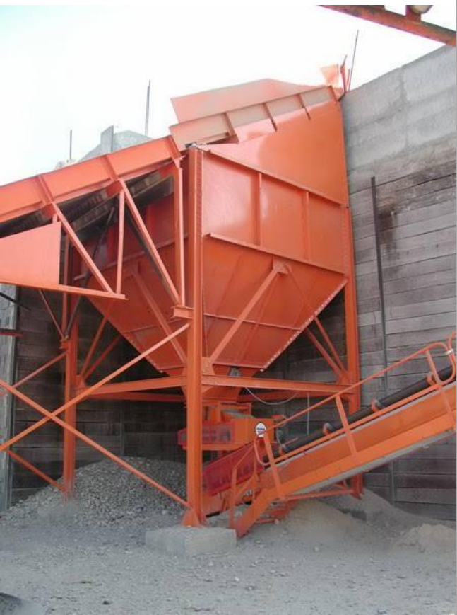
TOLVA DE ALMACENAMIENTO
